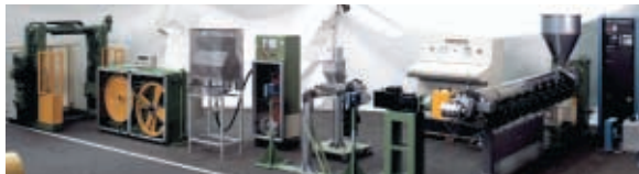
Beispiel für eine Anlage zur Fertigung von CATV- und HF-Kabeln Example of system used for the production of CATV and HF cables
