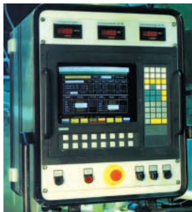
Bedienmonitor mit Schwenkarm am Extruderkopf
