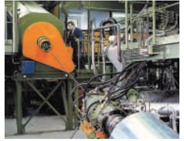
Beispiel für eine HV-CCV-Anlage mit Doppelrotationstechnik Example of an HV-CCV system with twin rotation technology
