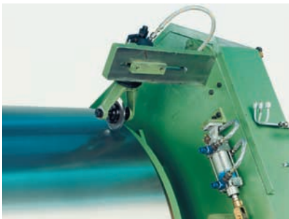
Rückseite mit Randschneidmesser Rear view with edge cutting knives
